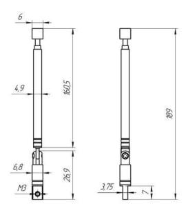
Тип антенна телескопическая поворотная
