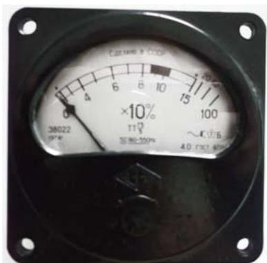
Щитовые малогабаритные приборы перегрузочный амперметр Э8022 состоят из следующих конструктивных узлов: измерительного механизма, корпуса и экранов. Амперметр Э8022 предназначен для измерения тока в цепях переменного тока в приводах металлорежущих станков. Вибропрочный, тряскопрочный, ударопрочный, пылезащищенный, брызгозащищенный.
