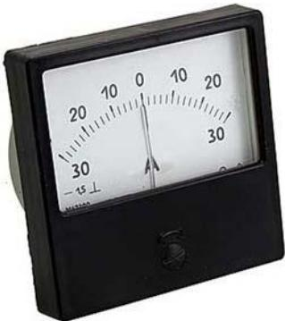
Амперметр М42300 предназначен для измерений тока в электрических цепях постоянного тока. Приборы представляют собой щитовые приборы магнитоэлектрической системы с внутрирамочным магнитом; Измерительный механизм прибора состоит из магнитной системы (обойма, магнитопровод), отсчетного устройства (шкала, указатель) и подвижной части на кернах;
