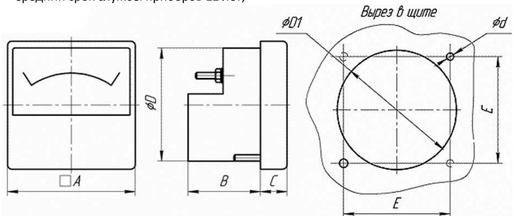
где А - 80мм, В - 36мм, С - 14мм, D - 70мм, D1 - 77,5мм, d - 3,4мм, E - 68,2мм;
