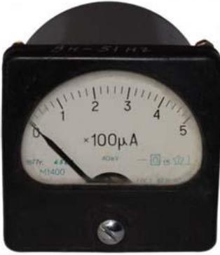
Микроамперметры М1400 постоянного тока, магнитоэлектрической системы с креплением подвижной части на растяжках, с механическим противодействующим моментом, виброустойчивые, ударопрочные предназначены для встраивания в измерительную и испытательную аппаратуру и в изделия, эксплуатируемые в полевых условиях при повышенных механических и климатических воздействиях. Используются в основном в изделиях оборонных отраслей промышленности.
