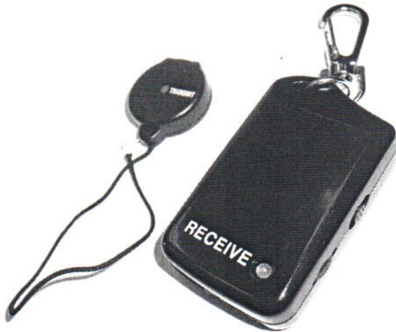
Рис.1 Общий вид системы (брелок-передатчик и приемник)
