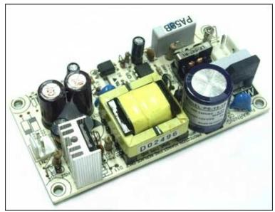
Надежный импульсный источник питания, обладающий малыми габаритами, минимальным числом внешних пассивных элементов обвязки, широким диапазоном питающих напряжений.
