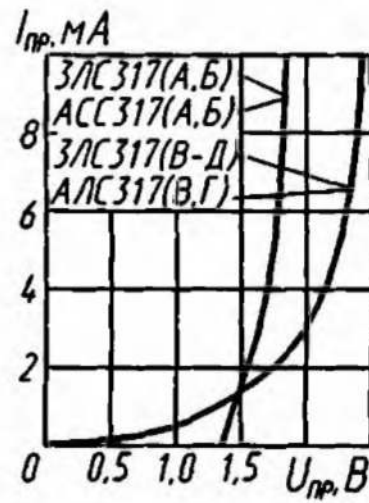
Зависимость прямого тока от напряжения
