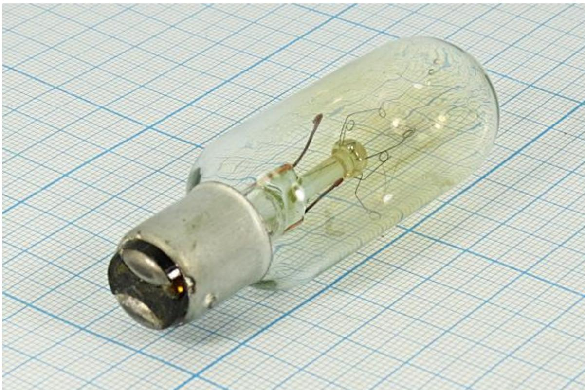
Лампы накаливания с цилиндрической колбой Ц 220-230-15 (цоколь В15d) предназначены для установки в световые приборы и оборудование. Используются для сигнализации, освещения шкалы приборов и других целей. Применяются в сигнальной аппаратуре на диспетчерских и распределительных щитах.
