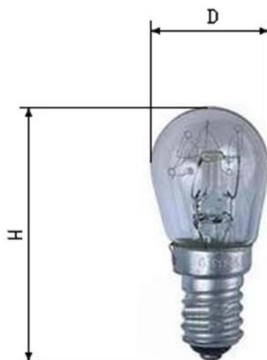
**Рабочее напряжение 130 в, мощность 15 Вт, D = 25 мм, H = 55 мм. Цоколь E14.**
