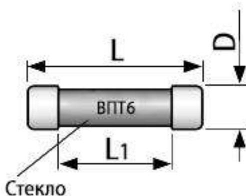
Габаритные и установочные размеры вставки плавкой ВПТ6.
