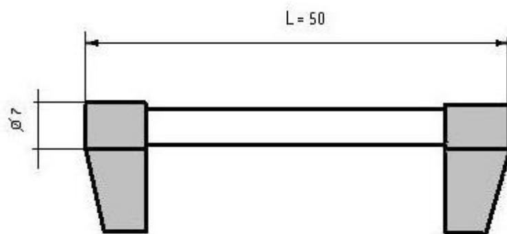
ПРЕДОХРАНИТЕЛЬ СТЕКЛЯННЫЙ, С НОЖЕВЫМИ КОНТАКТАМИ. Номинальное напряжение 600 вольт. Диапазон рабочих температур от минус 60 до плюс 100 градусов (Ц).
