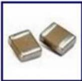
Керамические конденсаторы SMD ввиду их малых габаритов иногда маркируются кодом, состоящим из одного или двух символов и цифры. Первый символ, если он есть — код изготовителя (напр. K для Kemet, и т.д.), второй символ — мантисса и цифра показатель степени (множитель) емкости в pF. Например S3 — 4.7nF ( $4.7 \times 10^3$  Pf) конденсатор от неизвестного изготовителя, в то время как KA2 100 pF ( $1.0 \times 10^2$  PF) конденсатор от фирмы Kemet.
