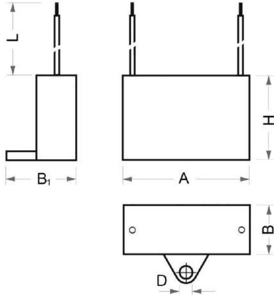
Конденсаторы серий СВВ61 предназначены для работы в цепях переменного тока промышленной частоты 50/60Гц. Применяются, в частности, как пусковые и рабочие конденсаторы для запуска электродвигателей переменного тока, а также в бытовых светильниках и другой электросетевой аппаратуре. Выпускаются на напряжения 450 и 630V AC. При необходимости использования конденсатора
