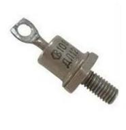
Выпускаются в металлостеклянном корпусе с жестким выводом прямой полярности.
