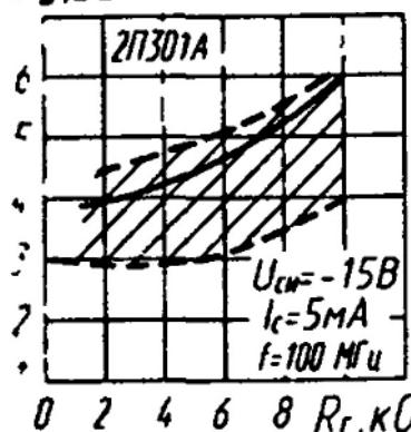
Зона возможных положений зависимостей коэффициента шума от сопротивления генератора
