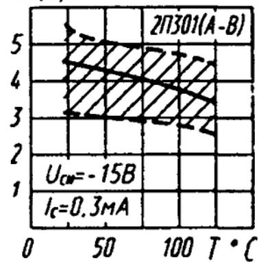
Зона возможных положений зависимости порогового напряжения от температуры
