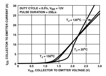
FIGURE 5. COLLECTOR TO EMITTER ON-STATE VOLTAGE
