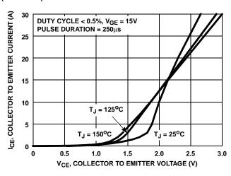
FIGURE 6. COLLECTOR TO EMITTER ON-STATE VOLTAGE
