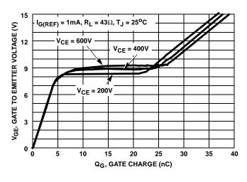
FIGURE 14. GATE CHARGE WAVEFORMS
