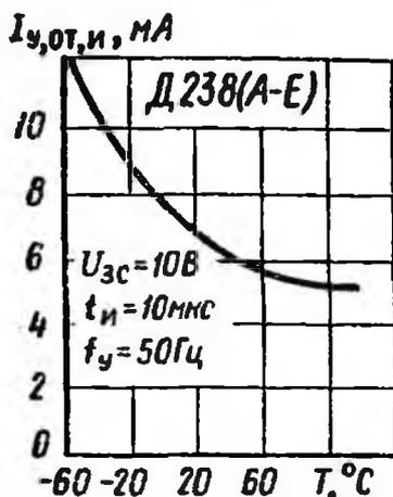
Зависимость отпирающего импульсного тока управления от температуры
