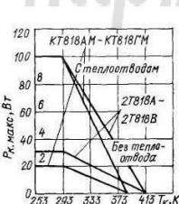
Зависимость максимально допустимой постоянной рассеиваемой мощности коллектора от температуры корпуса.
