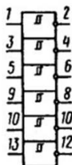
Условное графическое обозначение К155ТЛ2
