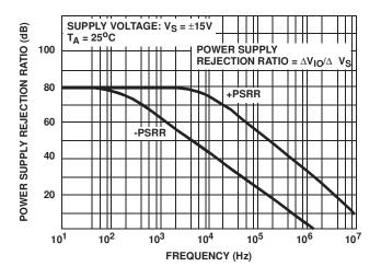
FIGURE 20. POWER SUPPLY REJECTION RATIO vs FREQUENCY
