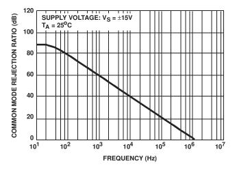
FIGURE 18. COMMON MODE REJECTION RATIO vs FREQUENCY
