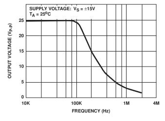
FIGURE 17. MAXIMUM OUTPUT VOLTAGE SWING vs FREQUENCY
