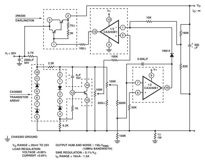
FIGURE 8. CONSTANT-VOLTAGE/CONSTANT-CURRENT POWER SUPPLY
