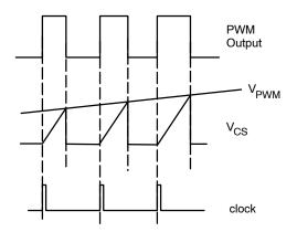
Figure 31. Current-Mode Timing Diagram
