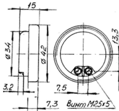
Предназначен для работы в аппаратуре связи. Выпускается 3-х видов: высокоомные - с сопротивлением постоянному току 1600 Ом; низкоомные - с сопротивлением 50 Ом; среднеомные - 100 Ом .
