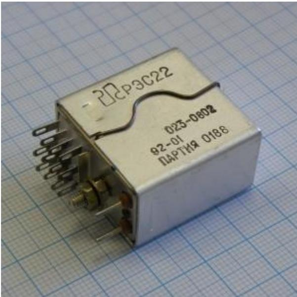
Реле РЭС22 – зачехленное, двухпозиционное, одностабильное реле, с четырьмя группами переключающих контактов с обмоткой постоянного тока. Предназначено для коммутации электрических цепей, преимущественно постоянного и переменного тока.
