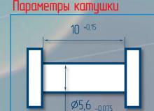
5000 витков, провод Ø 0,063 мм Сопротивление катущки 790±10%
