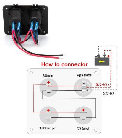
Клеммы на задней панели обозначены знаками «+» и «-» для положительного и отрицательного полюсов
