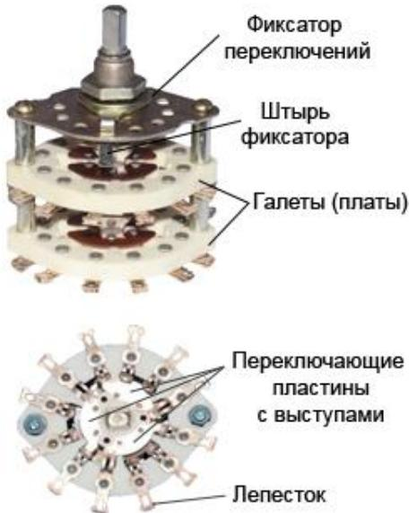
Устройство галетных переключателей ПГК: Переключатель галетный керамический ПГК состоит из фиксатора переключений и галет (плат). Фиксатор переключений закрепляет положения и ограничивает движение подвижной части переключателя. Штырь фиксатора переключений вставляется в отверстие, тем самым определяет число положений.
