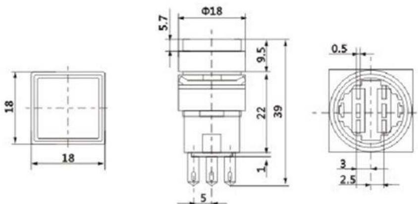
Переключатель предназначен для коммутации электрических цепей с рабочим напряжением 250 вольт и током нагрузки до 3 ампер. Посадочный диаметр на приборную панель 16 мм.
