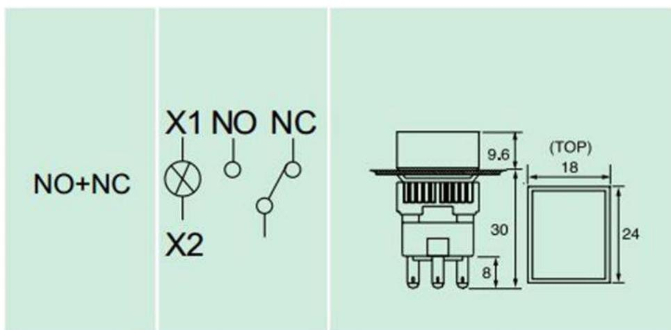
Переключатель предназначен для коммутации электрических цепей с рабочим напряжением 12 вольт и током нагрузки до 5 ампер. Посадочный диаметр на приборную панель 16 мм.
