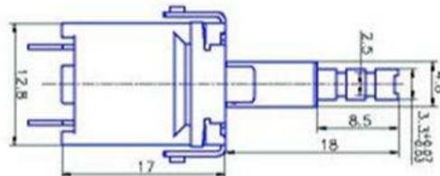
Сетевой двухконтактный выключатель с максимальным током нагрузки 5 ампер.
