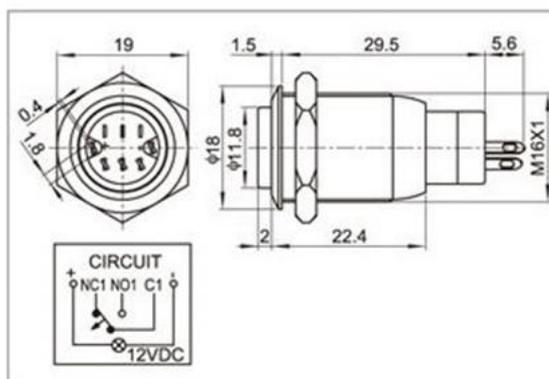
**Переключатель предназначен для коммутации электрических цепей с рабочим напряжением 12 вольт и максимальным током нагрузки 3 ампера. Переключение без фиксации (non-lock).**
