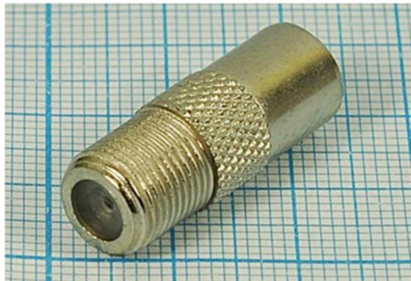
**Переходник имеет никелированный центральный контакт и никелированный корпус. Изолятор изготовлен из полиэтилена (полистирола). Назначение переходника – сопряжение TV разъемов с кабелями и устройствами имеющими разъемы стандарта F-типа.**
