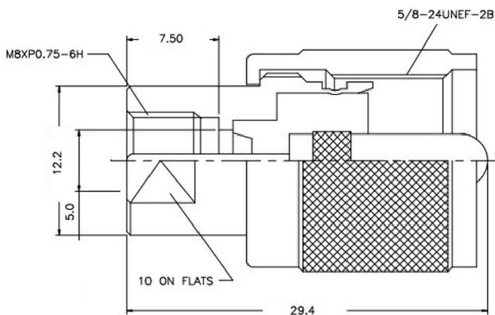
**Переходник предназначен для стыковки кабелей и приборов, имеющих соответствующие ответные части разъемов FME и UHF. Переходник имеет позолоченный центральный проводник и хромированный корпус. Изолятор, как правило, изготовлен из фторопласта.**
