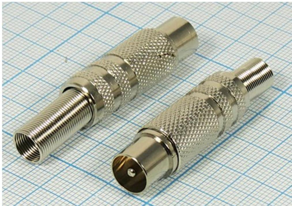
**Разъем имеет никелированный центральный контакт и никелированный корпус. Материал изолятора допускает применение фторопласта, полиэтилена, полистирола. Разъем предназначен для быстрого монтажа без применения пайки. Центральная сигнальная жила кабеля крепится винтом, оплетка кабеля, экран, обжимается. Возможно применение кабелей с диаметром внешней оболочки до 6 мм.**
