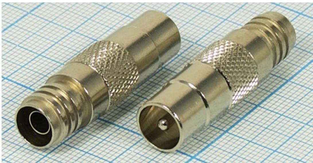
**Разъем имеет никелированный центральный контакт и никелированный корпус. Материал изолятора допускает применение фторопластика, полиэтилена, полистирола. Разъем предназначен для быстрого монтажа без применения пайки, но с использованием специального обжимного инструмента.**
