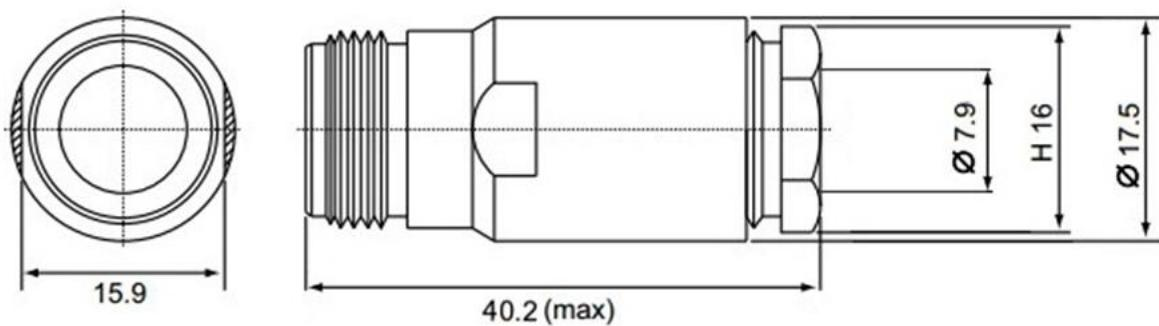
**Разъем имеет позолоченный центральный проводник и хромированный корпус. Изолятор, как правило, изготовлен из фторопласта или из бакелита.**
