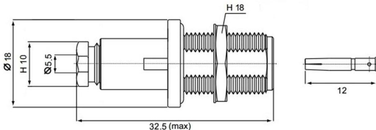
Разъем имеет позолоченный центральный проводник и хромированный корпус. Изолятор, как правило, изготовлен из фторопласта или из бакелита.
