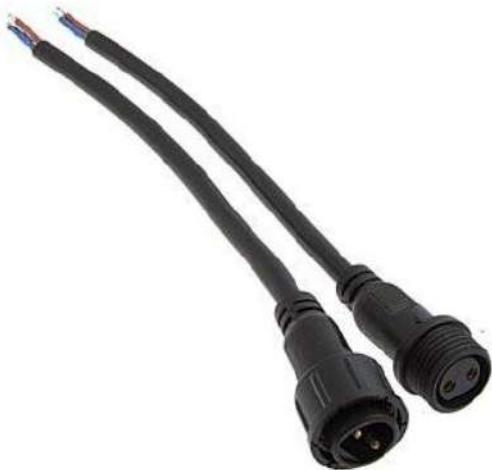
Герметичные разъемы марки 2pin WP L=40 D=19mm 2\*0.75mm2 находят широкое применение во всех областях электронной промышленности, медицинской технике, телекоммуникациях, машиностроении. Герметичность реализована на основе применения уплотнительных водонепроницаемых материалов. Разъемы имеют степень защиты IP65, что дает возможность использовать их на улице при повышенной влажности.
