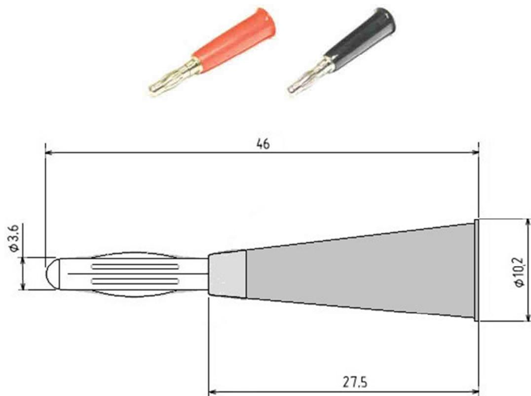
Цвет изолятора может иметь самую разнообразную цветовую гамму. Покрытие контактной части чаще никелированное или позолоченное.
